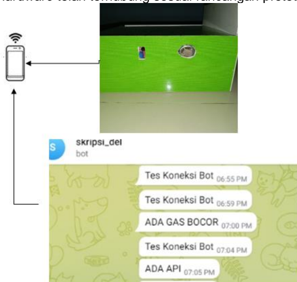
Gambar 8. Rangkaian Alat Terkoneksi ke Telegram
